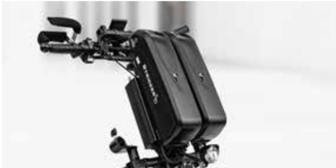
**48 V Zuggeräte - zwei Akkuhalter am Steuerlagerrohr**
