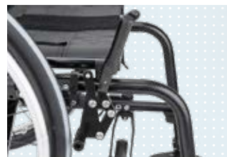
• Kniehebelbremse für Einhandbedienung
