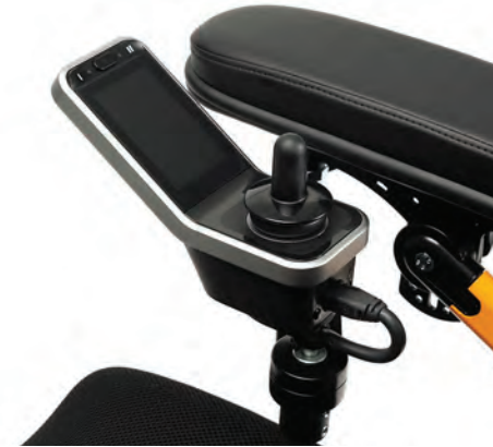
SE53A - abschwenkbare Steuerung mit Verriegelungspositionen
