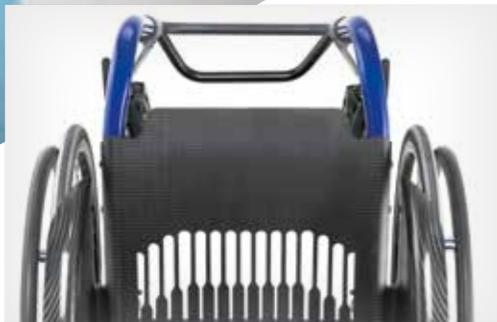
Feste Carbon-Sitzplatte mit beweglichen Lamellen im hinteren Bereich für eine perfekte Druckverteilung und eine angenehme Sitzposition
