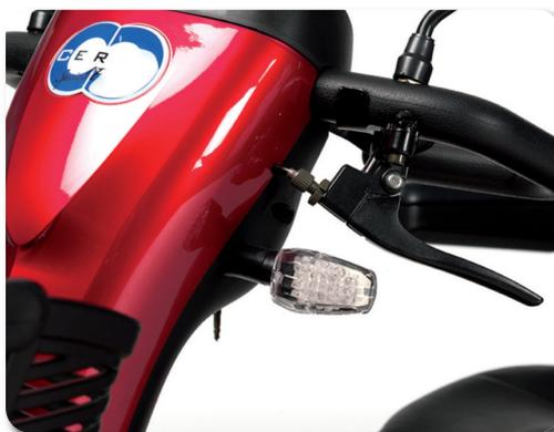
Beleuchtung und Fahrtrichtungsanzeigern, Rückspiegel links und rechts, und Handbremse
